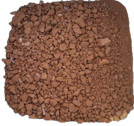
Resim 2. Pişmiş öğütülmüş kırmızı çamur kırığı (A.C. KILIÇ, 2022)
