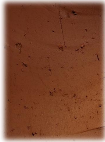
Resim 4. Şamotlu kırmızı çamur, 1500 gr kırmızı çamur, 25 gr şamot (A.C. KILIÇ, 2022)
