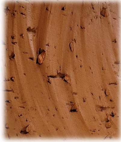
Resim 5. Şamotlu kırmızı çamur, 1500 gr kırmızı çamur, 400 gr şamot (A.C. KILIÇ, 2022)
